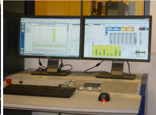
Rys. 2. Dynamiczne silnikowe stanowisko hamulcowe AVL DynoRoad 120: a) widok ogólny wraz z zainstalowanym silnikiem ZS 1,3 SDE, b) pulpit sterujący
